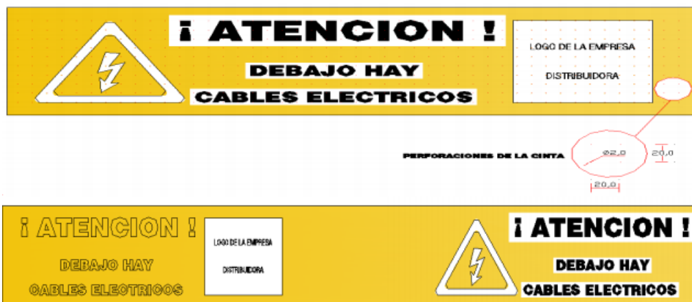
Fig. A-15.01_ 14 Cinta de señalización para indicar la presencia de red eléctrica soterrada.
